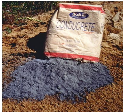
चित्र 3.2 : सेट होने से पहले और बाद का अर्थ एन्हांसमेंट मटेरियल (Earth Enhancement Material Before & After Setting)
