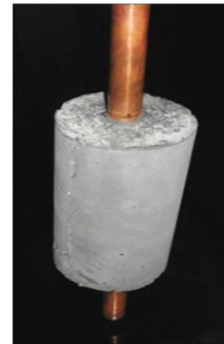
चित्र 3.2 : सेट होने से पहले और बाद का अर्थ एन्हांसमेंट मटेरियल (Earth Enhancement Material Before & After Setting)
